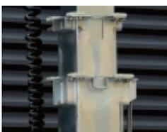
Телескопическая мачта изготовлена из оцинкованной стали 8 мм. 9 секций компактно складываются в передней части генератора ручной лебедкой.
