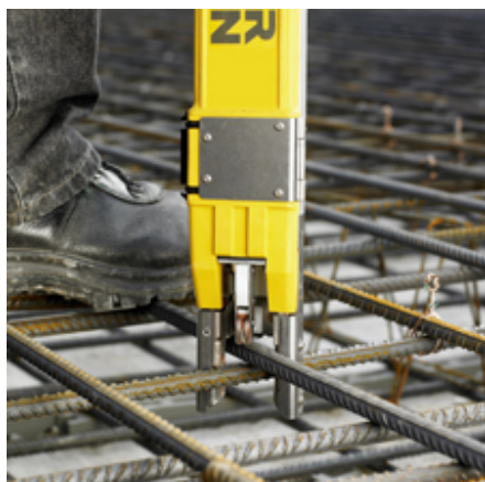
4. Потяните дальше до автоматического срабатывания механизма: Узел затягивается
